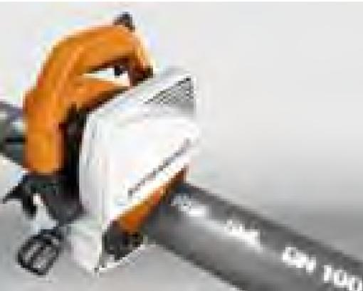
Rohrabschneider oder elektrische Rohrsägen (z. B. PIPECUT von Rothenberger) verwenden
